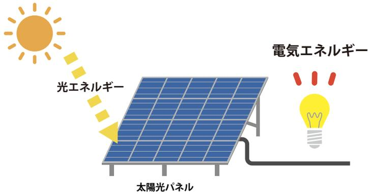
太陽光パネルは、太陽の光エネルギーを電気エネルギーに変換します。
